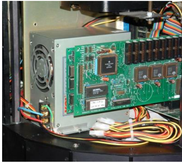
Figura 3.4: Alimentatore ATX all'interno del robot.
