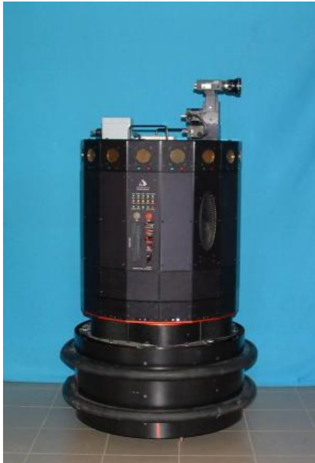
Figura 2.1: Il robot mobile Nomad 200.
