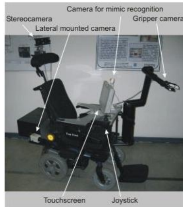
Figura 1.10: Sistema di supporto per disabili basato su carrozzina, manipolatore e telecamera.
