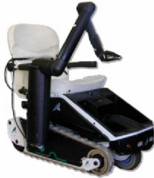
Figura 2.5: Il Manus nella configurazione TGR Explorer
