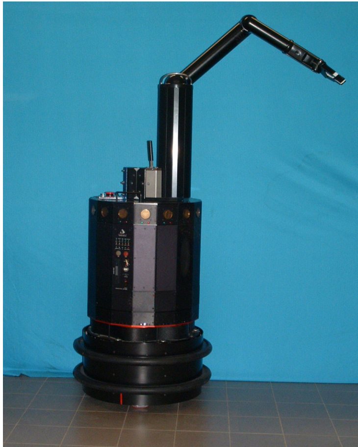
Figura 3.1: Il manipolatore mobile.
