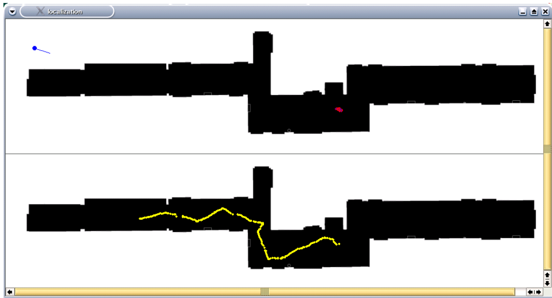
Figura 5.7: Esempio di visualizzazione in fase di simulazione: in alto a sinistra è indicata la posizione del robot; sulla prima mappa sono rappresentate le particelle, mentre sulla seconda il logging sulla posizione stimata.
