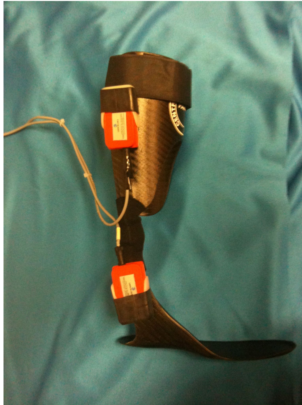
Figura 3.10: Prima versione del prototipo di ortesi strumentata con sensori MTx.
