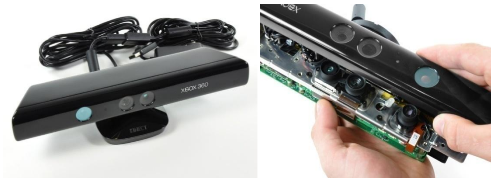
Figura 2: Sulla sinistra il dispositivo Kinect e sulla destra i sensori che permettono l'acquisizione delle immagini e della profondità
