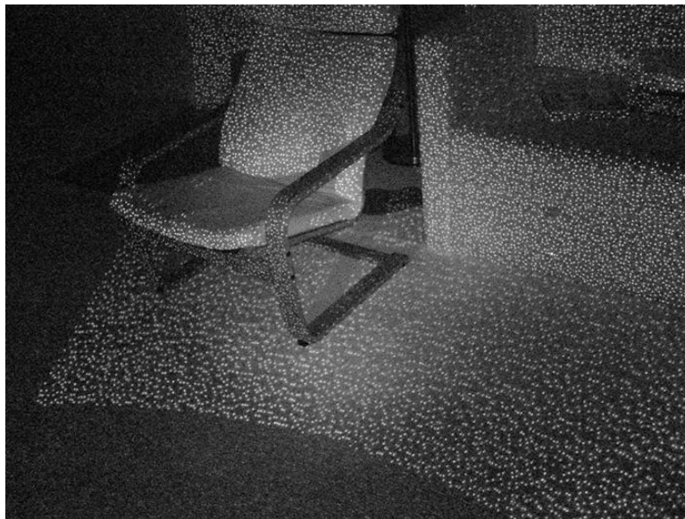
Figura 6: Il fascio di infrarossi proiettato dal Kinect
